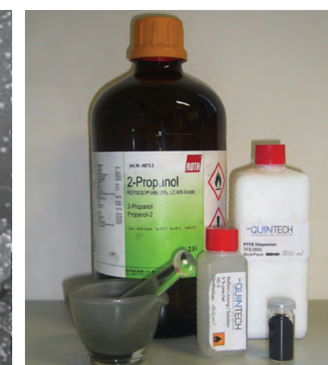
Bestandteile einer Katalysator-Dispersion
