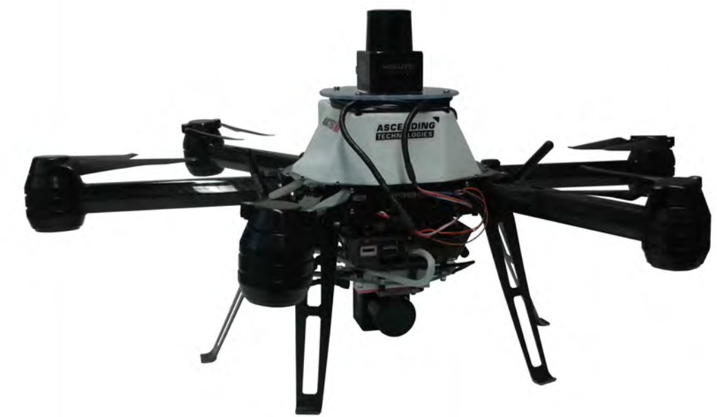
Abb. 2: Flugdrohne AscTec Neo, ausgerüstet mit Kamera und Laserscanner.
