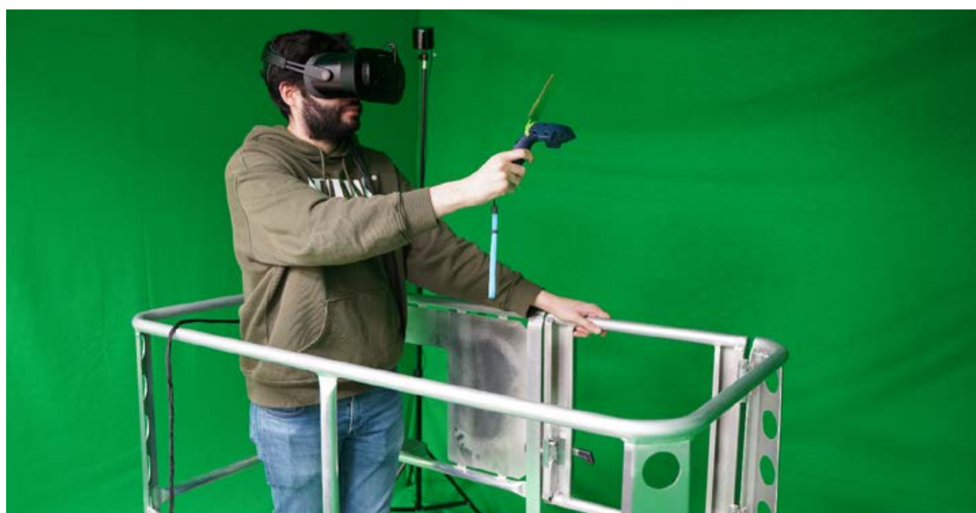
Greenscreen-Box und Headset für Mixed-Reality Umgebung
