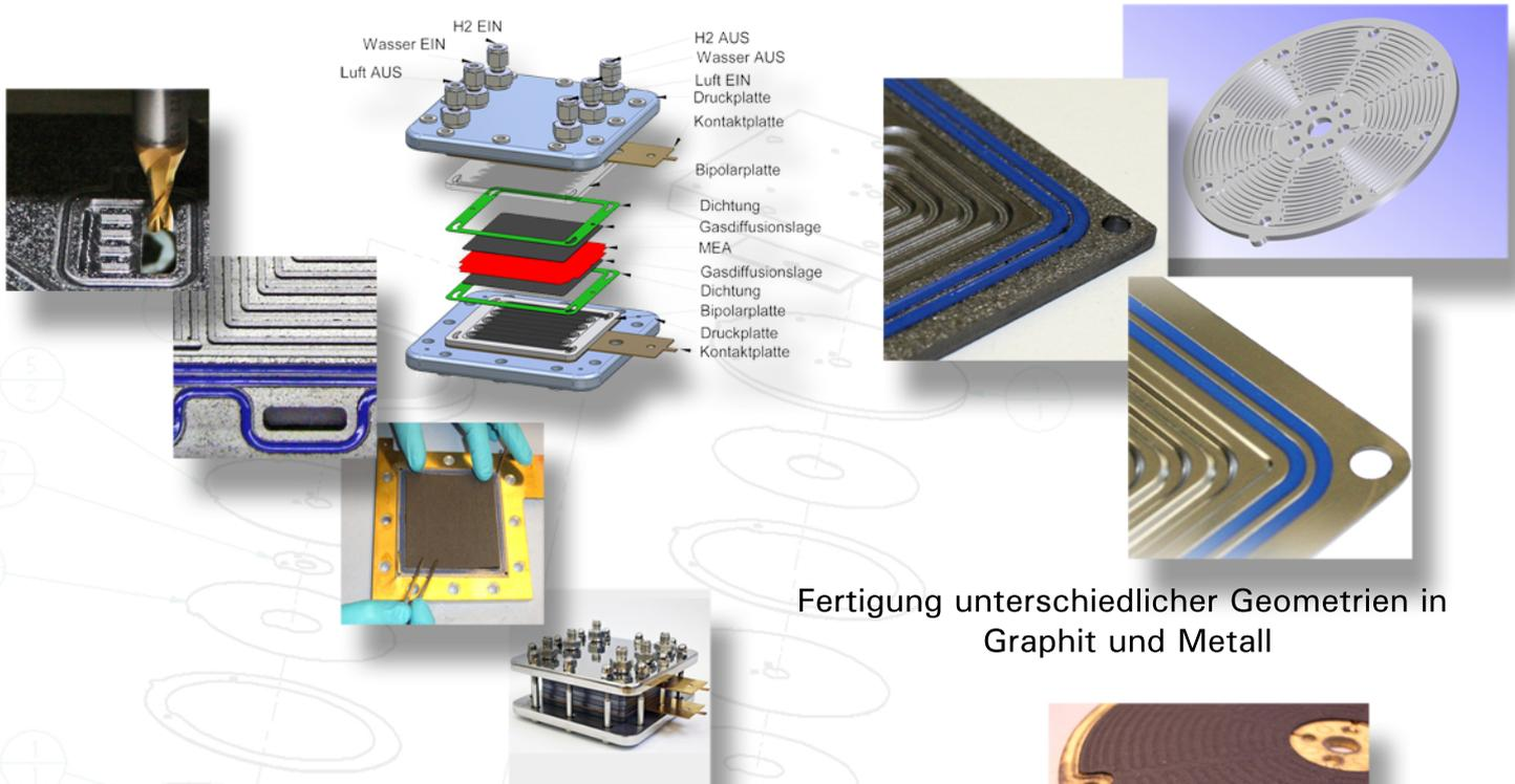
Fertigung unterschiedlicher Geometrien in Graphit und Metall
