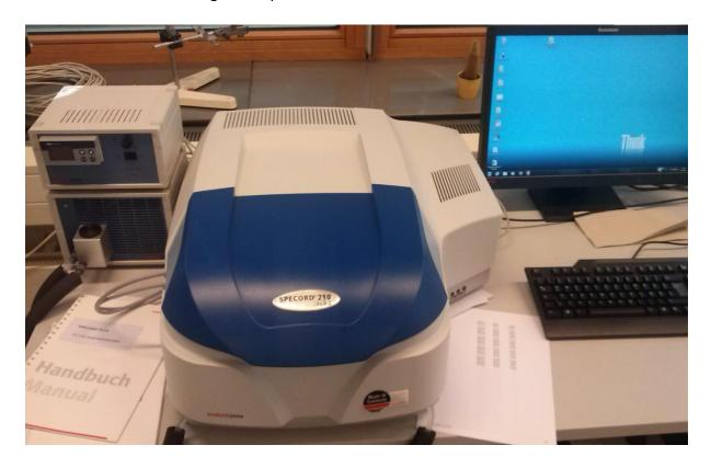
Die UV/VIS Spektrometer ist mit einem Peltierelement versehen, was eine Temperaturkontrolle der Probenmessung von 0-95° C erlaubt. Damit ist es möglich, Veränderung in biologischen Makromolekülen wie z. B. DNA und Proteinen unter Temperatureinfluss zu detektieren.
