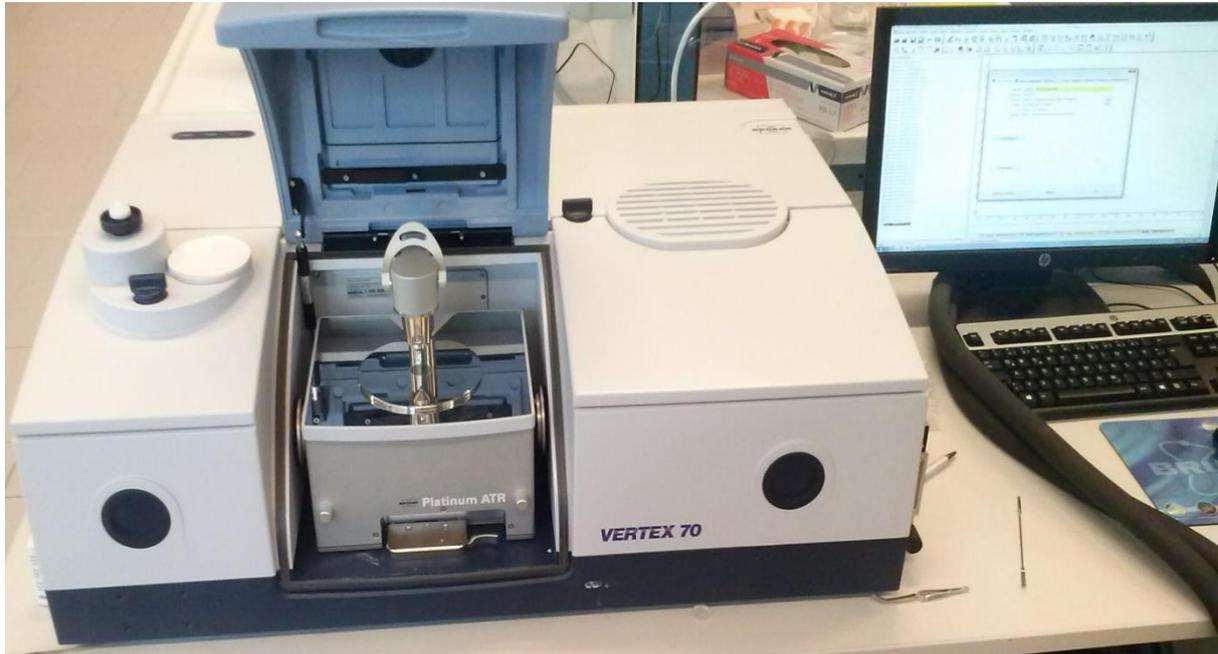
Durch einen modularen Aufbau können neben gängigen Feststoffuntersuchungen im MIR – und NIR-Bereich mittels ATR-Einheit auch über 2 spezielle Messzellen (*Aquaspec*, *BioATR II*) Proteine untersucht werden.
