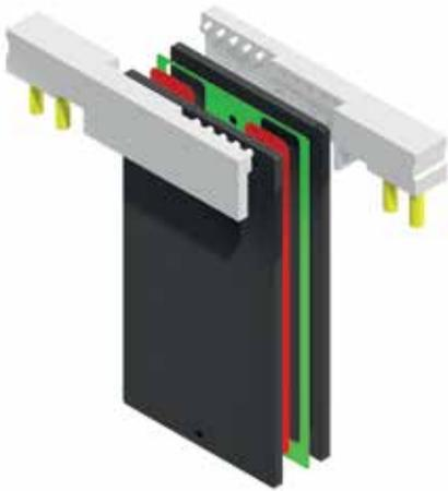
Abb. 2: Explosionsdarstellung einer Einzelzelle
