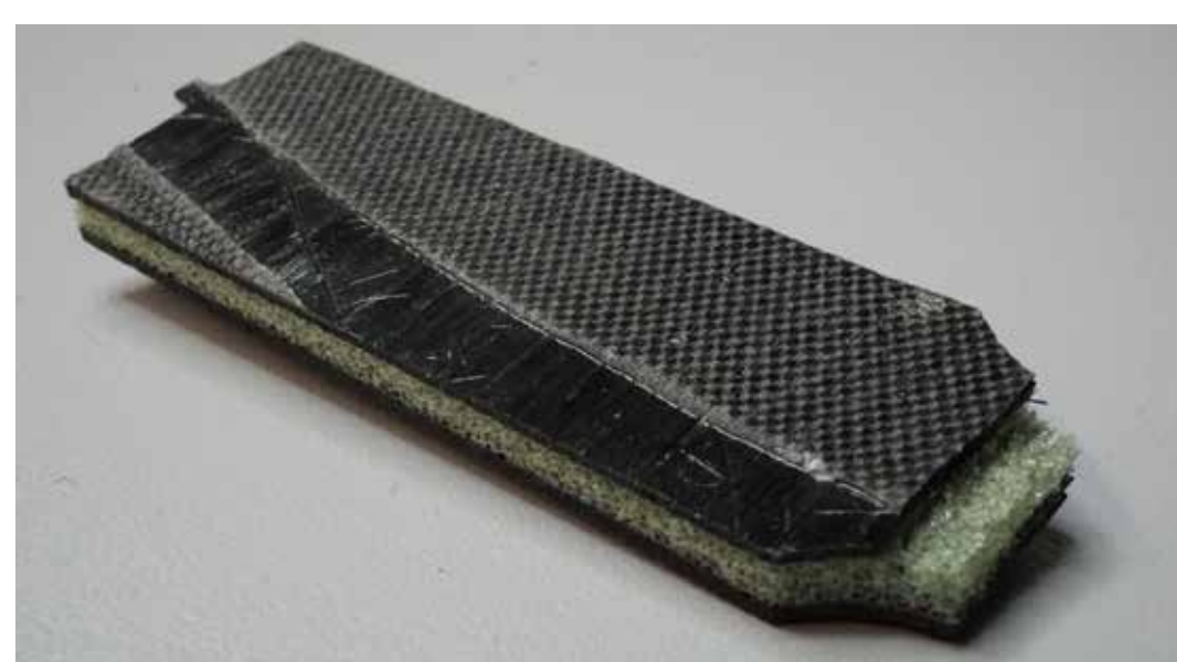
CFK Verbundmaterial mit Schaumkern, gebrochene Zugprobe
