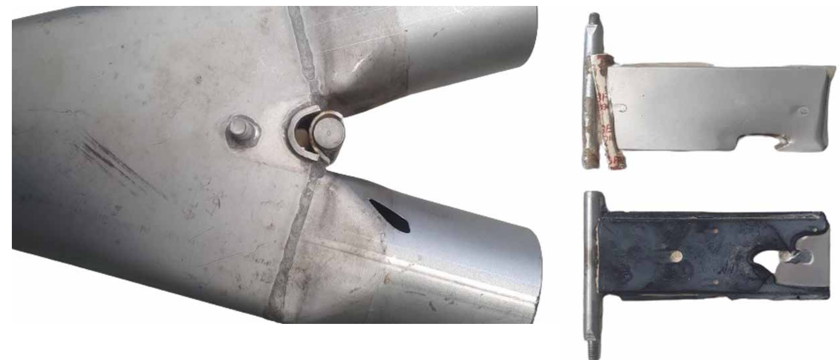
Abb. 1: Prototypische Futterweiche mit Abnutzungserscheinungen an unterschiedlichen Flippern
