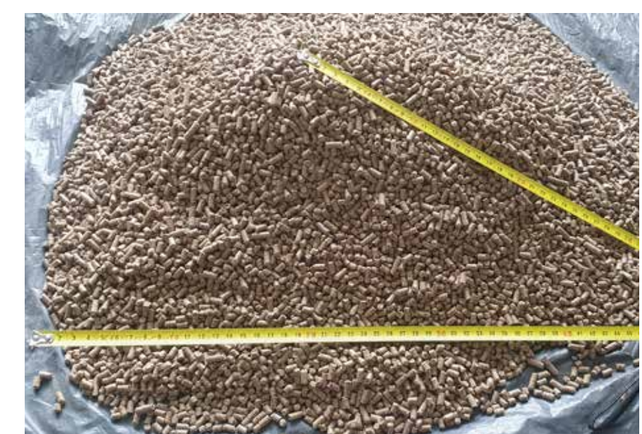
Abb. 2: Schüttwinkelversuch mit Futterpellets aus der Schweinefütterung
