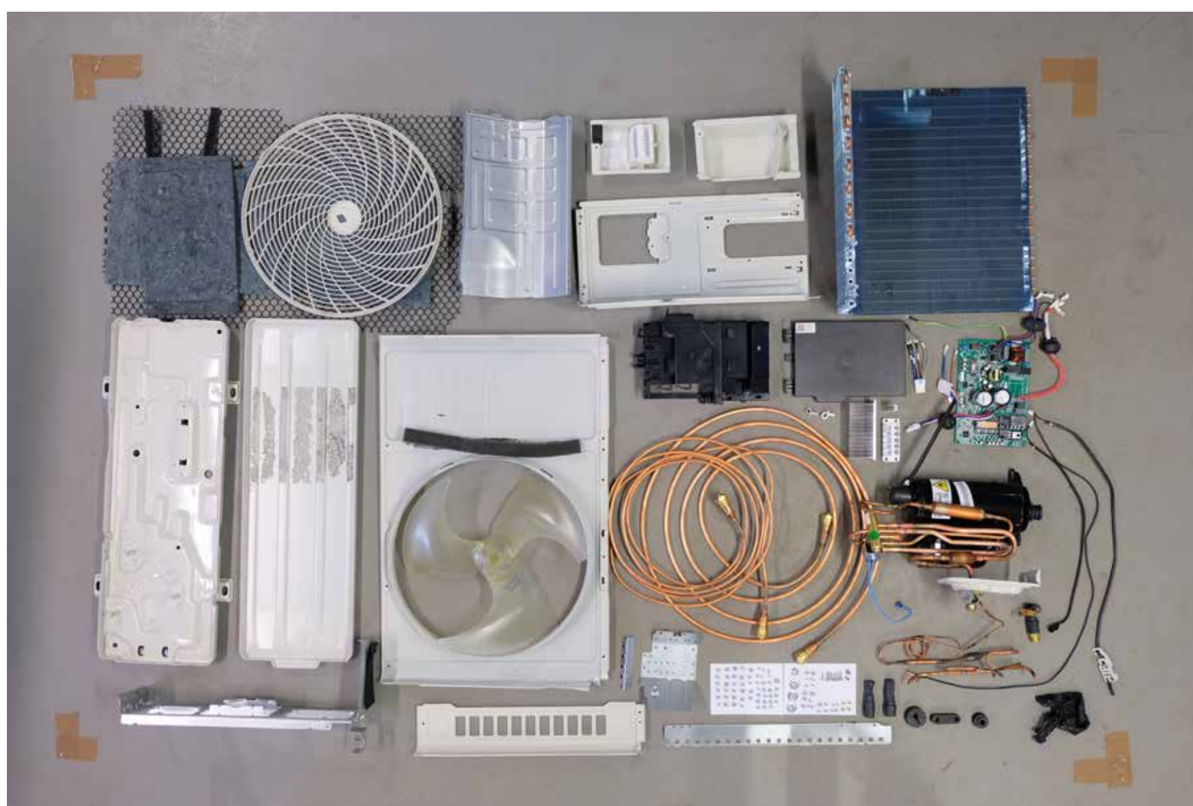
Abb 2: Untersuchung von Einzelkomponenten einer Luft-Luft-Wärmepumpe für den Einsatz im second-life (Eigene Darstellung)
