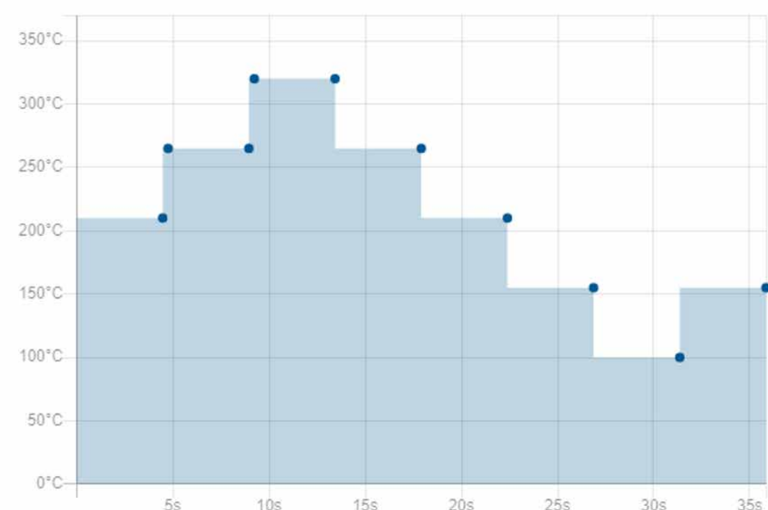
Abb. 2: Genutztes Heizprofil des MOX-Sensors. Durch die zyklische Änderung der Betriebstemperatur ergibt sich ein "Fingerprint" des zu detektierenden Gases
