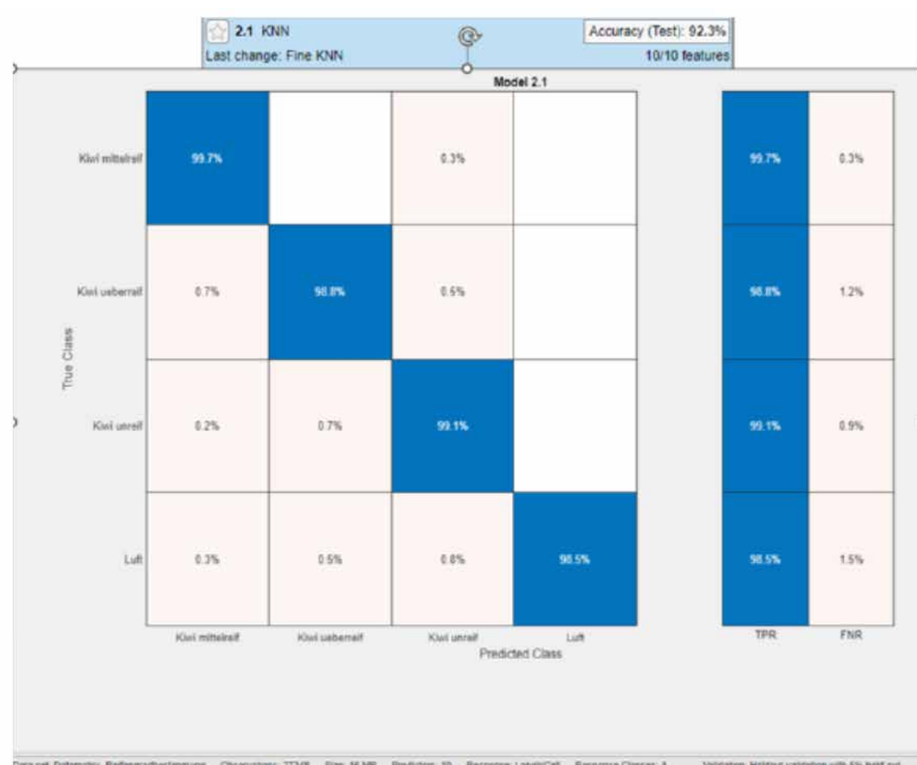
Abb. 3: Konfusionsmatrix mit untrainierten Sensordaten für Kiwi in verschiedenen Reifegraden sowie Luft
