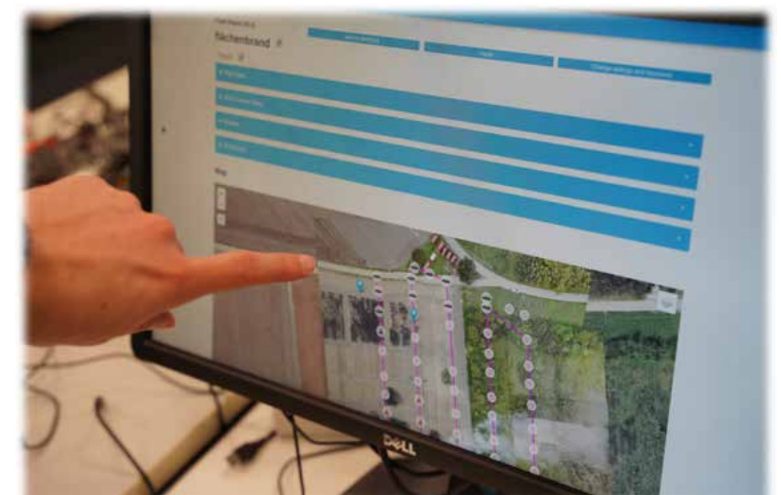
Abb. 6: Orthographisches Foto in ARGUS mit rekonstruierter Trajektorie des UAVs und eingebundenen Detektionen von Objekten.
