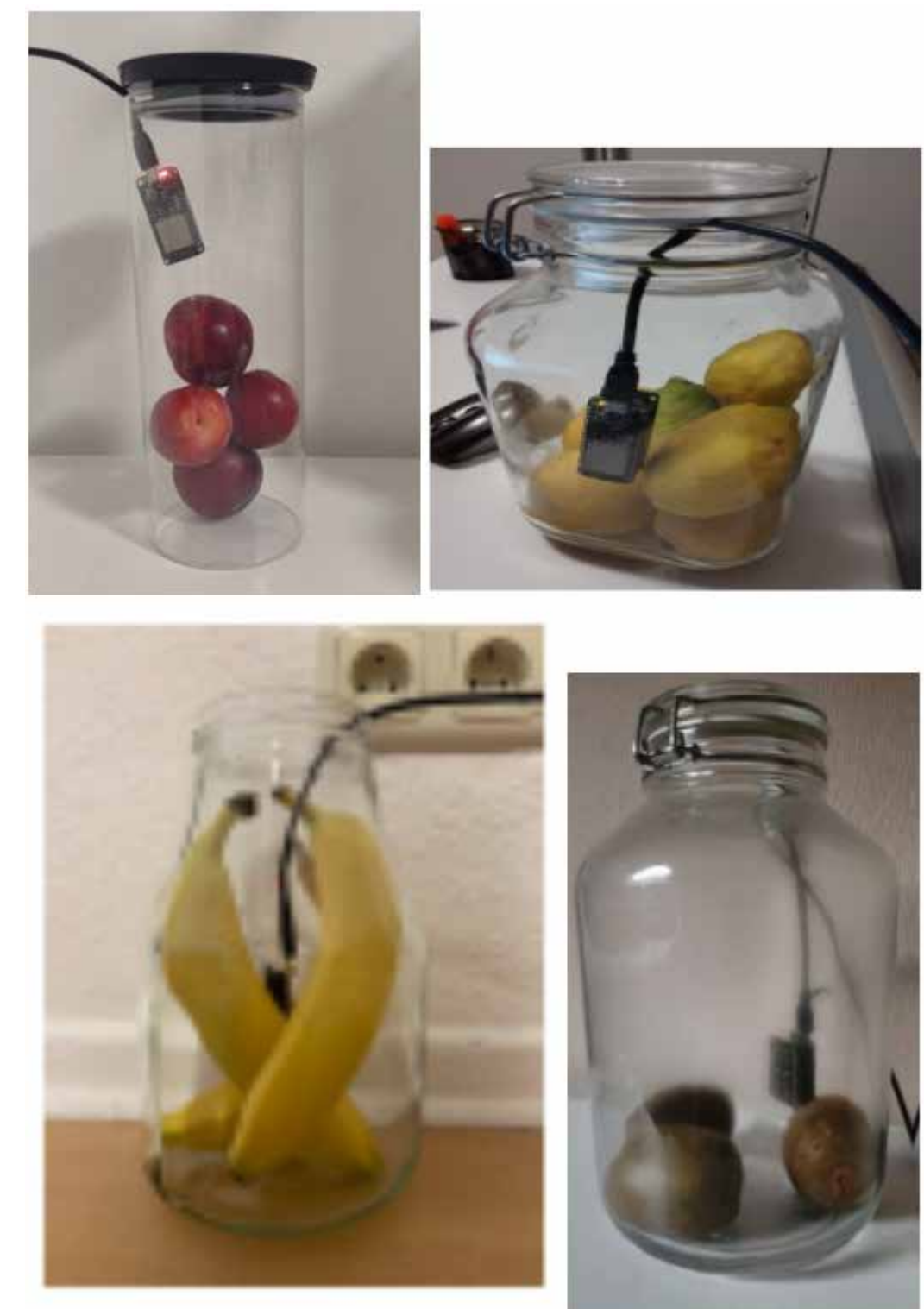
Abb. 2: Experimenteller Setup Training mit KI-Sensor und Früchten
