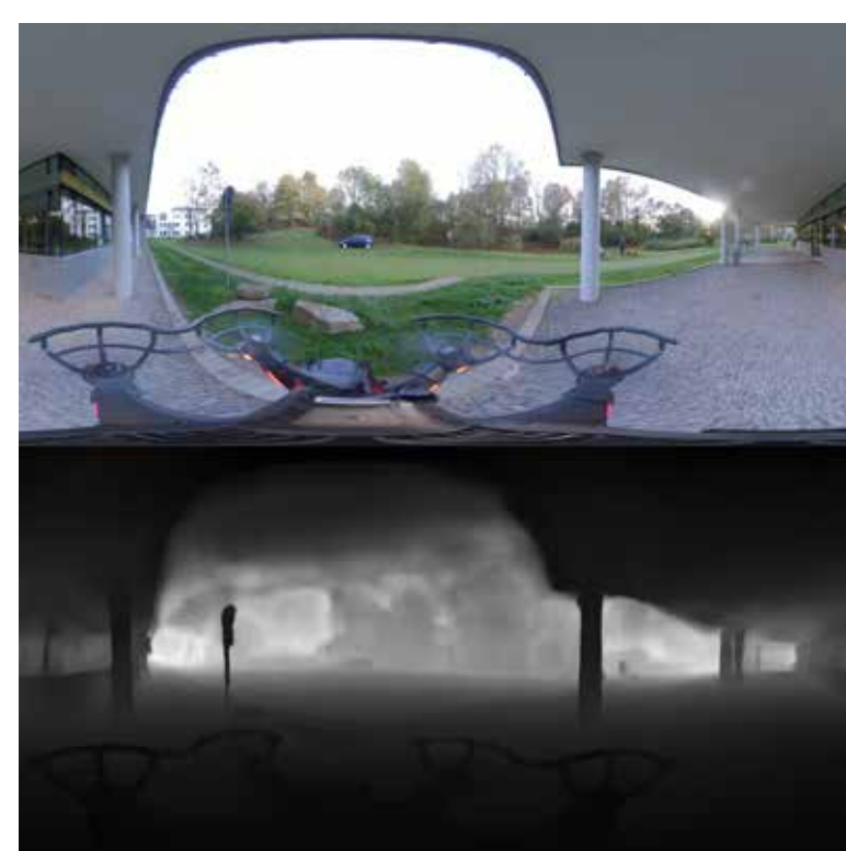
Abb. 5: 360° Tiefenbild erzeugt mit dem Visual Transformer DPT (unten) und das Ausgangsbild (oben).
