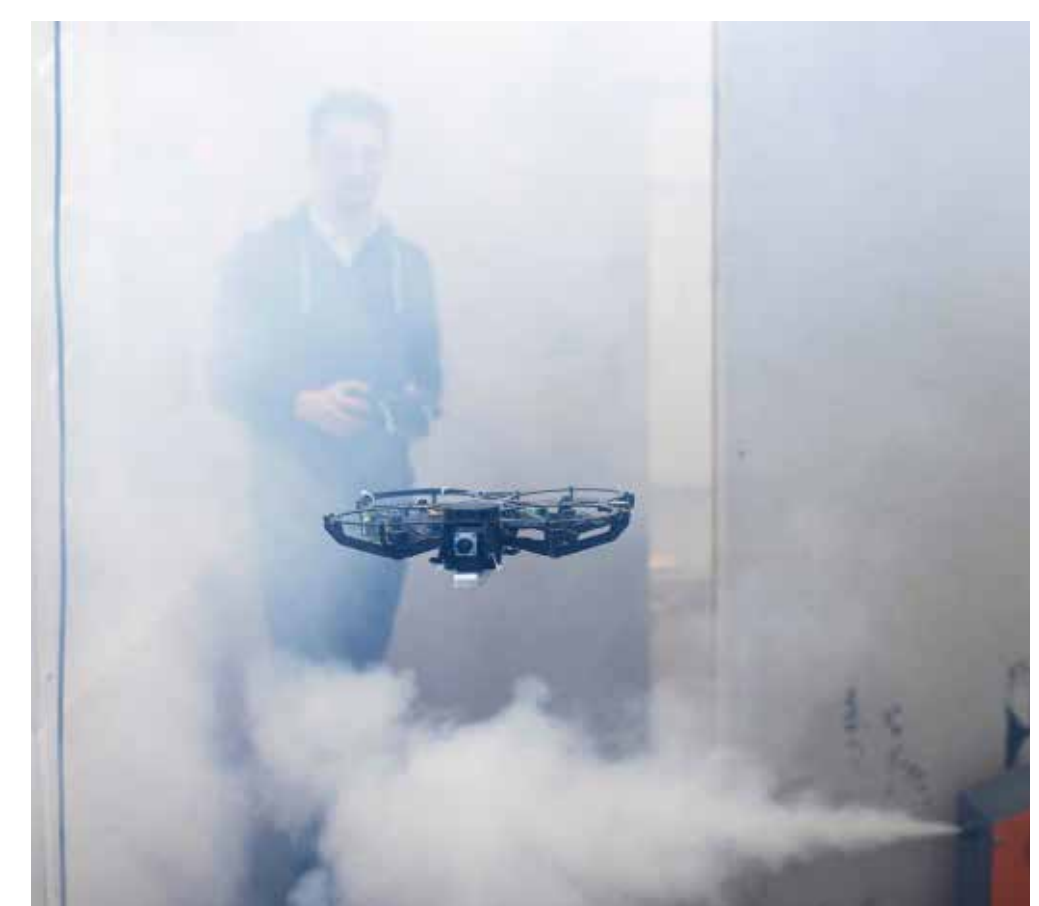
Abb. 3: Evaluierung der Drohnen-Sensorik unter starker Rauchbelastung.
