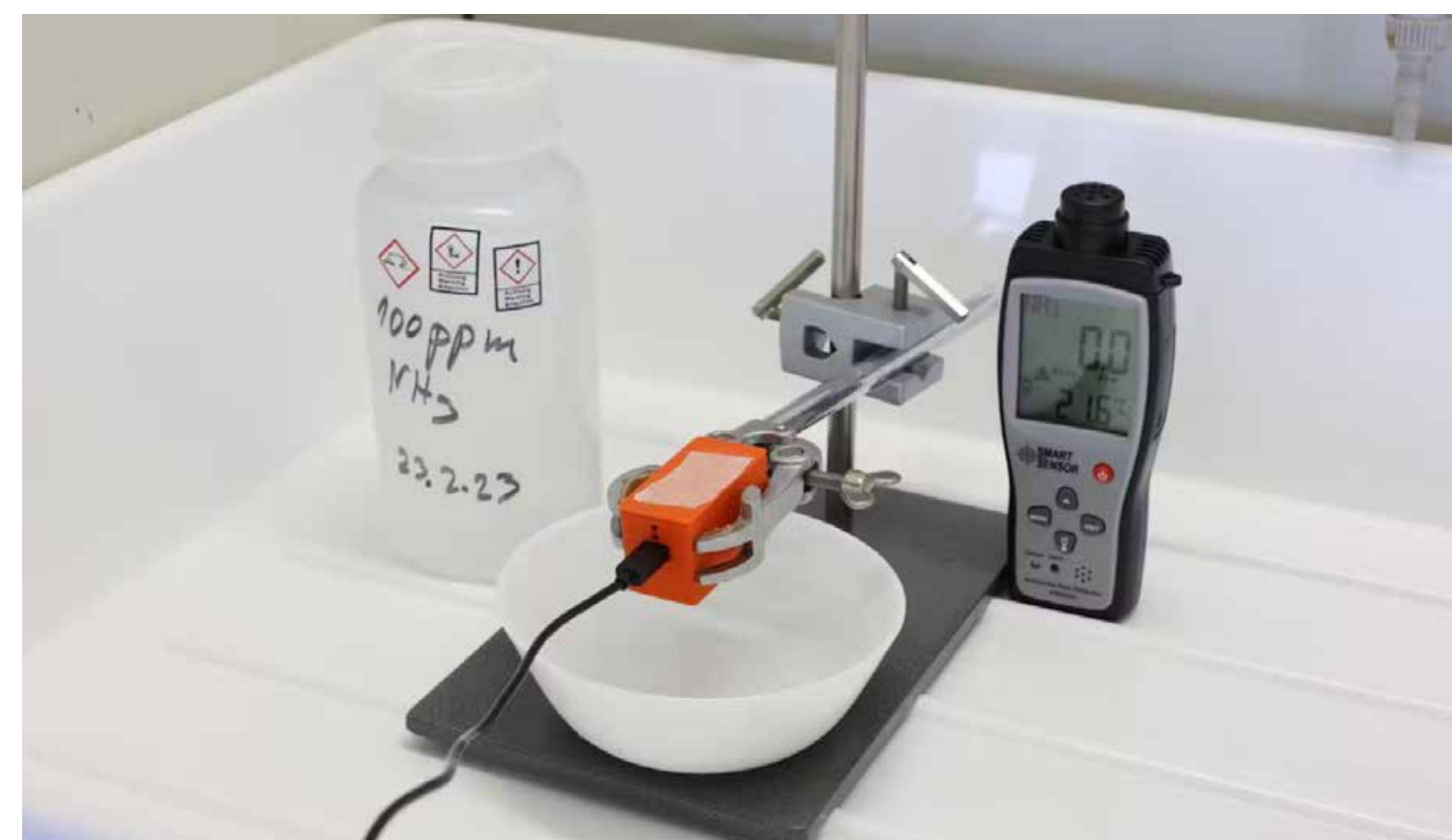
Abb. 1: Versuchsaufbau: Wässrige \text{NH}_3 -Lösung mit dem MOX-Sensorboard
