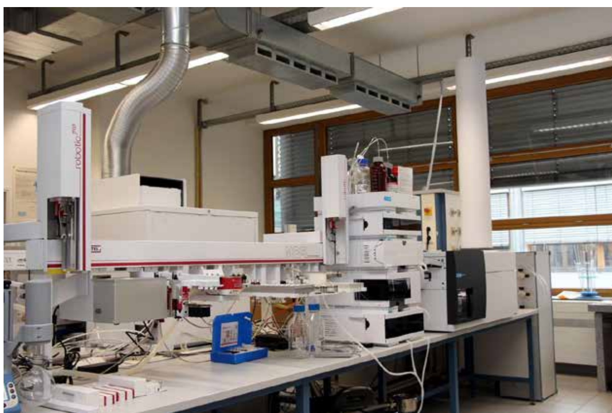
Abb. 2: Automatisierte Extraktion mit einem MPS Robotic-Laborroboter (links) und Flüssigkeitschromatografie und hochauflösender Flugzeitmassenspektrometrie (rechts)
