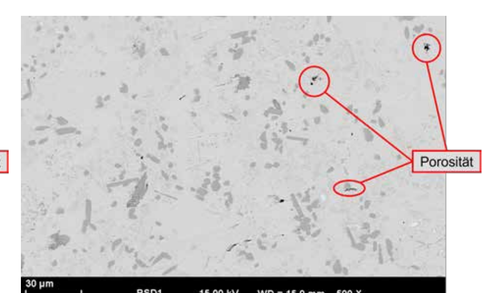
Abb. 5b: REM-Querschnittsaufnahme Probe nach Programm 2 verlötet
