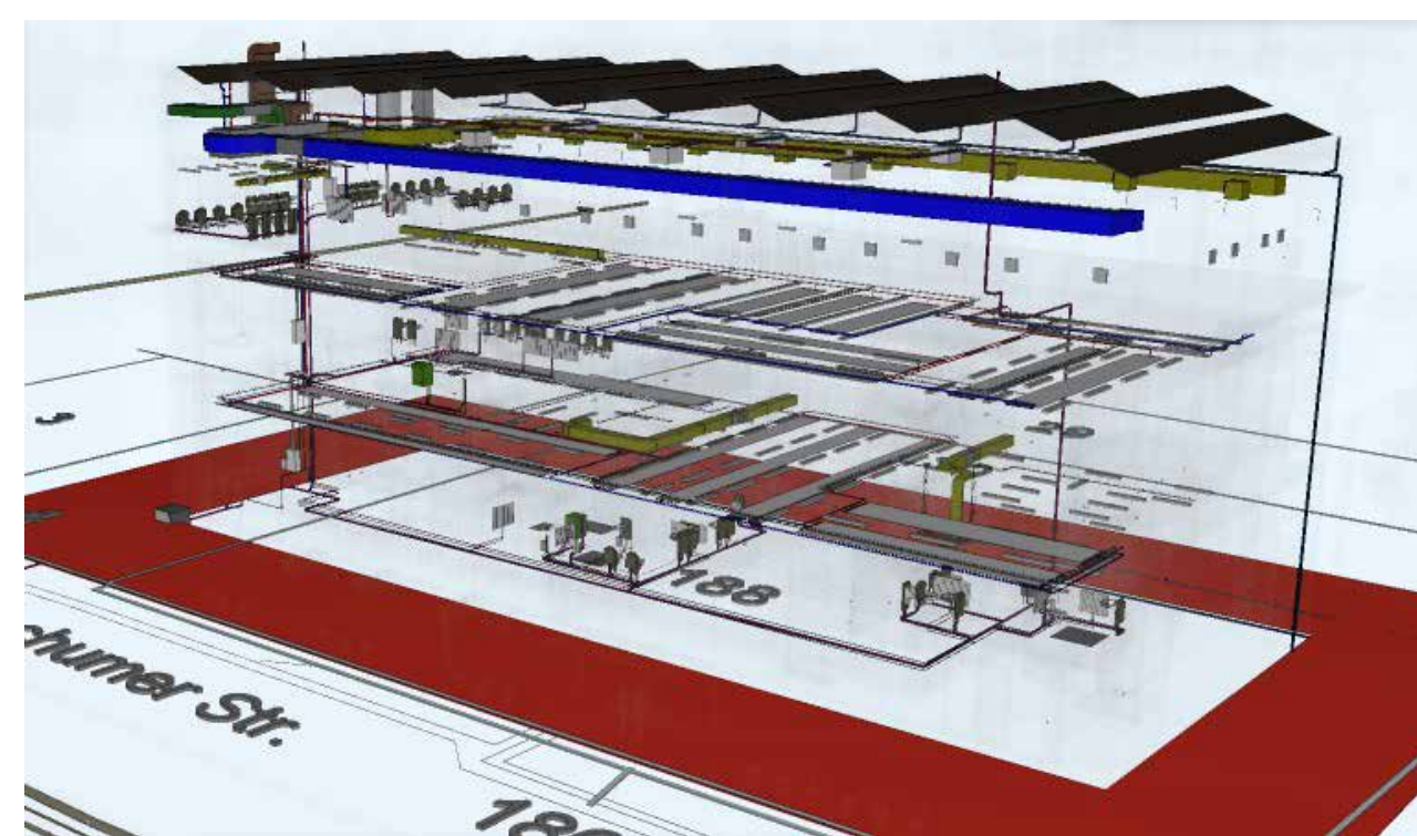
Abb. 6: Darstellung alle TGA-Installationen.
