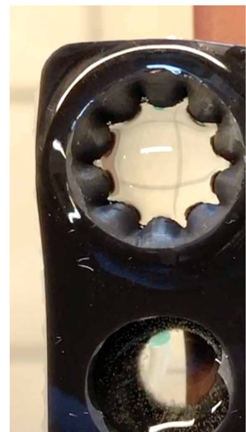
Abb. 4: Ausdehnung der Membran unter Druckluft
