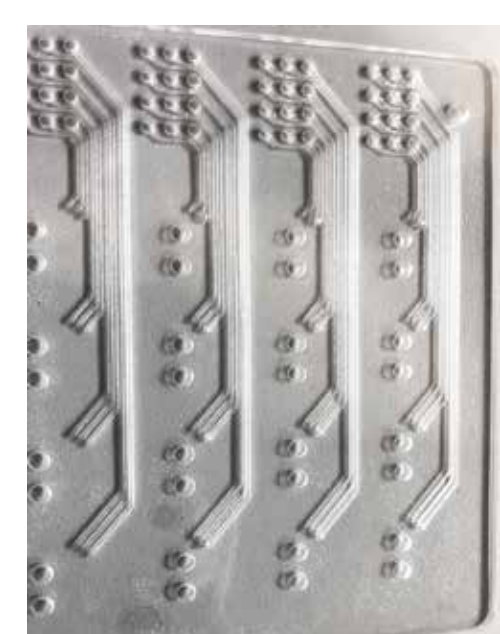
Abb. 5: Bodeneinheit mit Kanälen zur Gasversorgung
