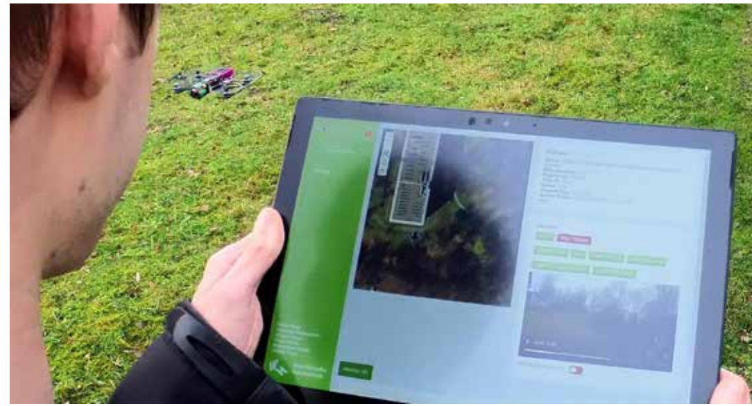
Abb. 2: Autonome Steuerung mittels Webanwendung auf einem Tablet
