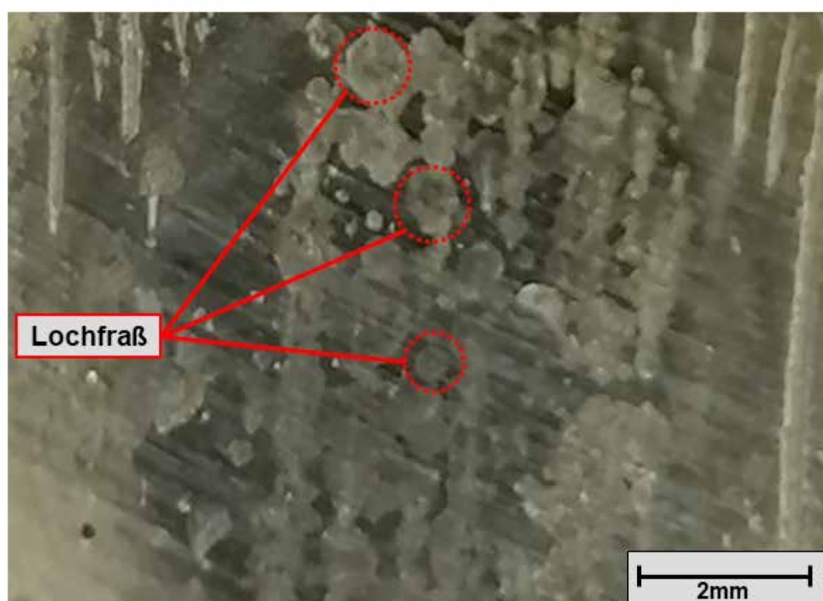
Abb. 5: „Lokaler Angriff durch Lochfraßkorrosion an der Oberfläche der hergestellten Probe“
