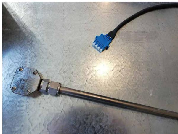
Abb. 2: Prototyp eines faseroptischen Beschleunigungsmessers für 150 °C und 70 bar mit 3 Achsen
