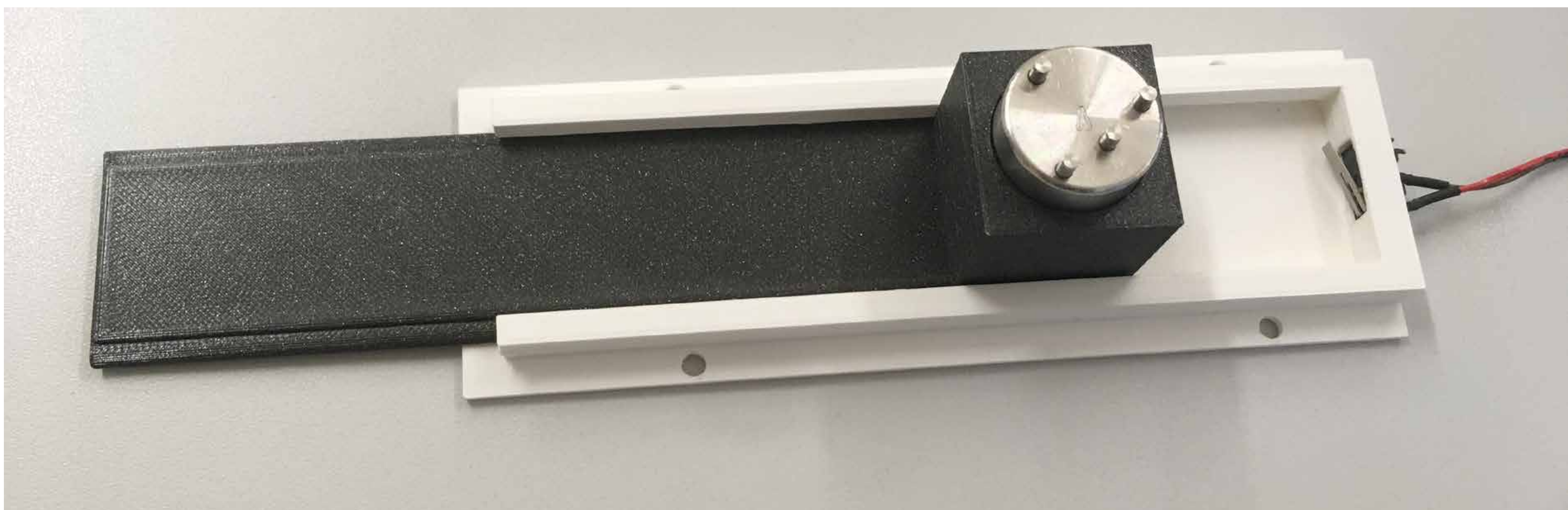
Abb 1: Führungsschiene zum Einführen eines Schließstempels (ein Teil des Schlosses) in die Apparatur. Der silberne Schließstempel weist vier zylinderförmige Erhebungen auf, die einen Teil des Schlüssel-Schloss-Mechanismus bilden und deren Position in der Bilderkennung bestimmt wird.
