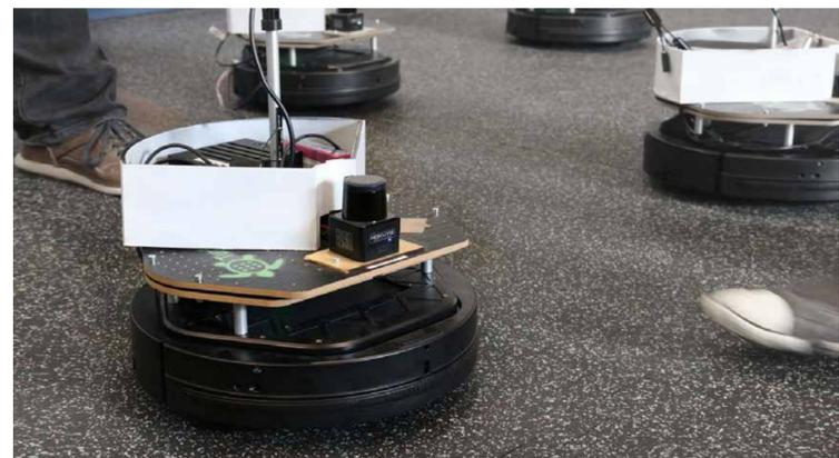
Abb 4: Kobuki-Roboter mit Laserscanner, Jetson Board und gedrucktem Tortenstück zur verbesserten Wahrnehmung durch andere Roboter.
