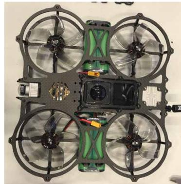
Bei der Erkundung von beschädigten Gebäuden besteht auch für kleine Drohnen ein hohes Risiko. Das Bild zeigt eine speziell entwickelte Opferdrohne mit 360° Kamera, wie sie bei der Erkundung des schweren Brands in Essen im Feb. 2022 eingesetzt wurden. Die sogenannten OpferUAVs fliegen Aufklärungsflüge mit hohem Verlustrisiko, ohne dabei an Funktionalität oder Flexibilität zu verlieren. Sie sind besonders modular, preisgünstig und haben einen Schutz für die Rotoren.
