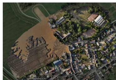
Orthophoto aus dem Überflutungsgebiet in Ertstadt / Blessem nach der Hochwasserkatastrophe in Westeuropa im Juli 2021. Die Berechnung eines Orthophotos dient zur detaillierten Darstellung und Orientierung eines Gebietes. Da diese georeferenziert sind, können Einsatzkräfte Messungen durchführen und Unterschiede feststellen, die durch eine Katastrophe entstanden sind.
