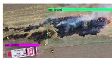
Durch den Robotereinsatz entsteht eine Bilderflut, die Einsatzkräfte in kritischen Situationen überfordern. Moderne KI-Verfahren sind bei der Bewältigung entscheidend, da sie semantische Informationen automatisch erfassen können wie hier Feuer und Fahrzeuge.
