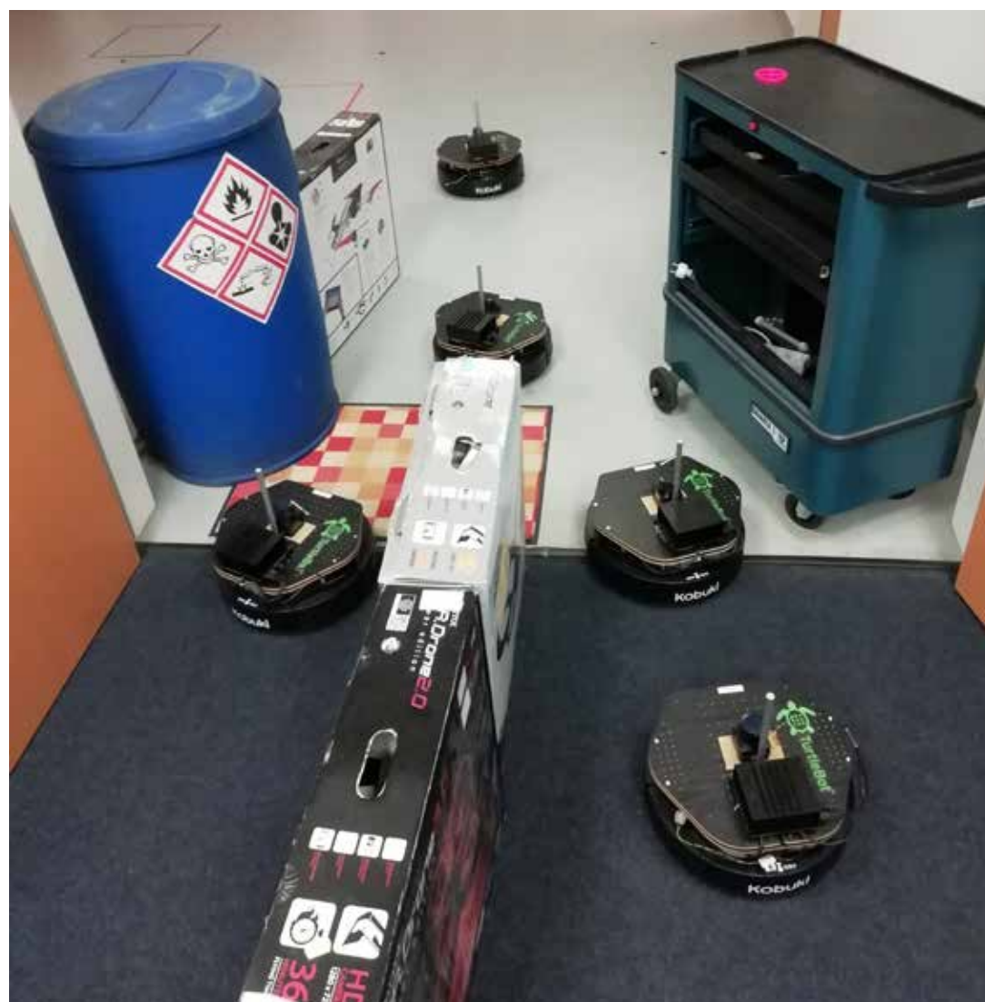
Abb 1: Treffen verschiedene Roboter aufeinander so reihen sie sich nach dem Reißverschlussverfahren ein. Das Verhalten haben die Roboter selbständig erlernt.
