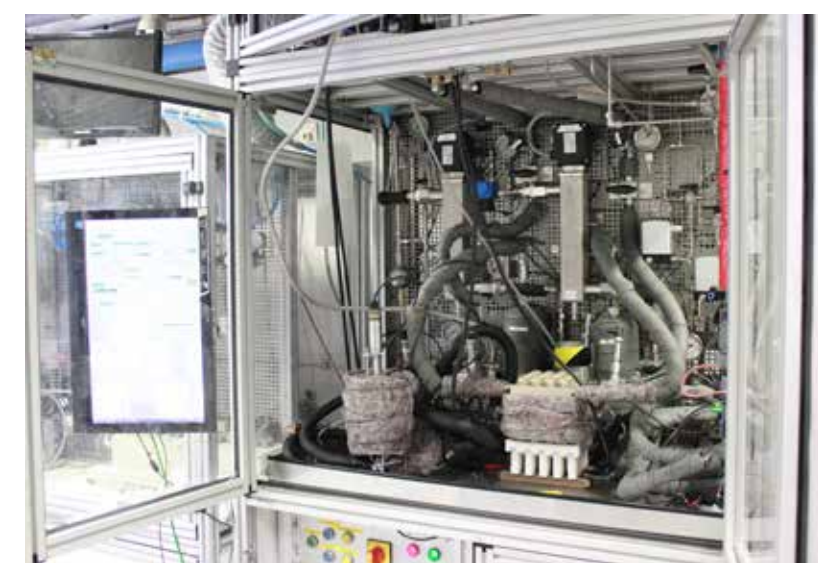
Abb 5: PEMEL-Prüfstand mit vier Zellen
