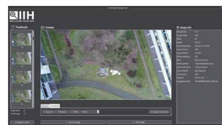
Abb 6: Ausschnitt aus dem Intelligent ImageHub, einer Softwarekomponente zur Analyse der UAV-Bilder mittels Deep Learning und zur Berechnung der 3D-Punktwolken.
