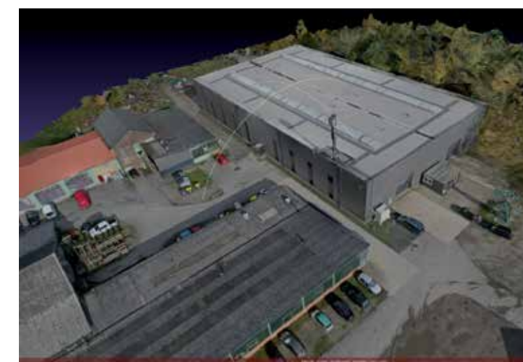
Abb 1: Texturiertes 3D-Modell der Halle des DRZs in Dortmund. Dieses wird aus mehreren hundert, hochauflösenden Bildern eines Flugroboters (UAV) rekonstruiert. Je nach Umfang und Qualität des Datensatzes wird leistungsstarke PC-Hardware oder sogar ein Rechnercluster benötigt.
