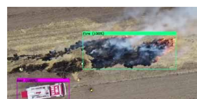
Abb 7: Durch den Robotereinsatz entsteht eine Datenflut, die Einsatzkräfte in kritischen Situationen überfordern können. Moderne KI-Verfahren sind bei der Bewältigung entscheidend, da sie semantische Informationen automatisch erfassen können.
