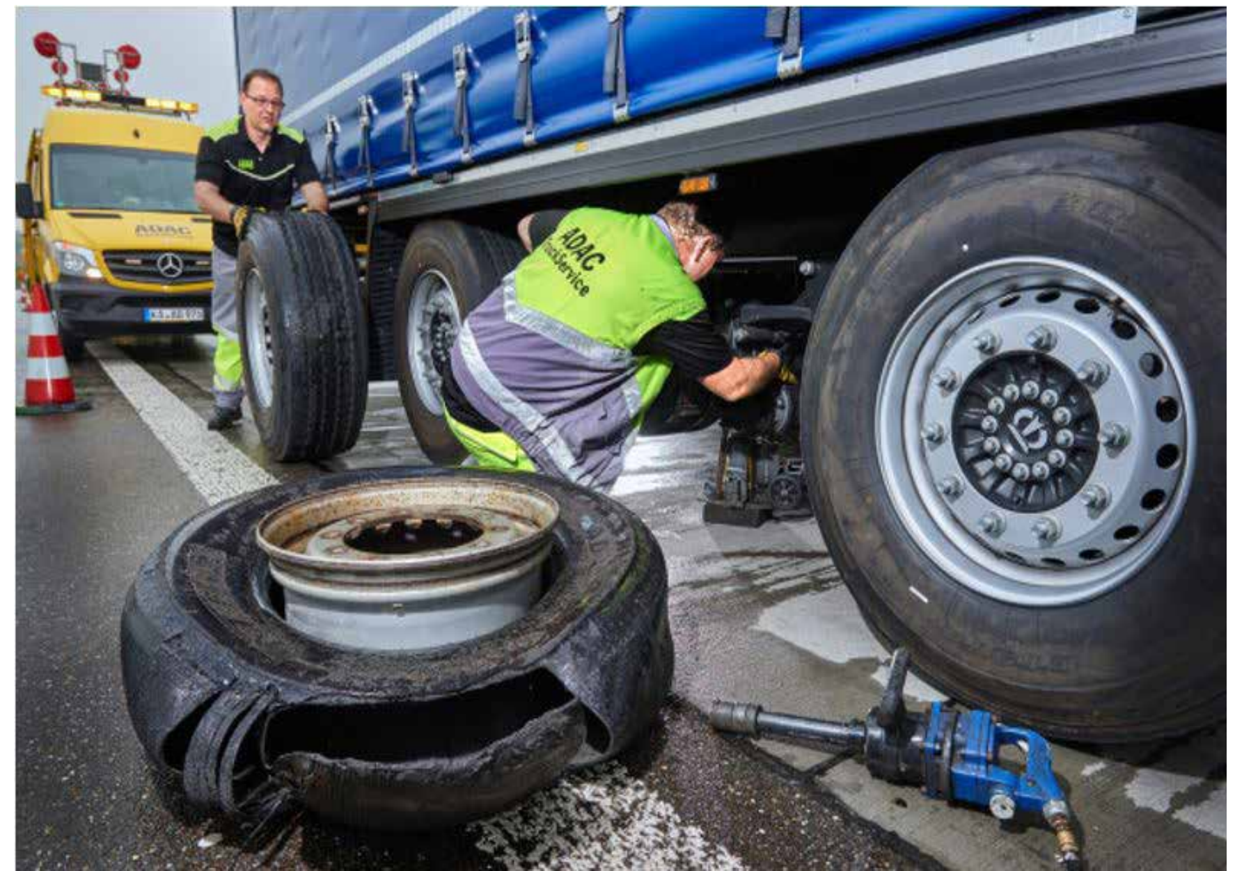
Abb. 1: Typischer Reifenschaden durch unzureichenden Reifendruck Quelle: (Wenn Lkw-Reifen Feuer fangen – Quelle: Verkehrsrundschau 28.3.2019)
