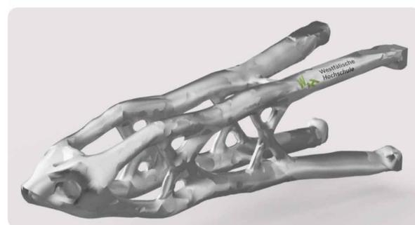
Abb. 4: Ein mit der LSM optimierter Biegebalken im STEP-Format. (Minimierung der Nachgiebigkeit bei einer Reduktion der Masse auf 15% des Vollmaterials. Optimierung ohne Fertigungsrestriktionen!)
