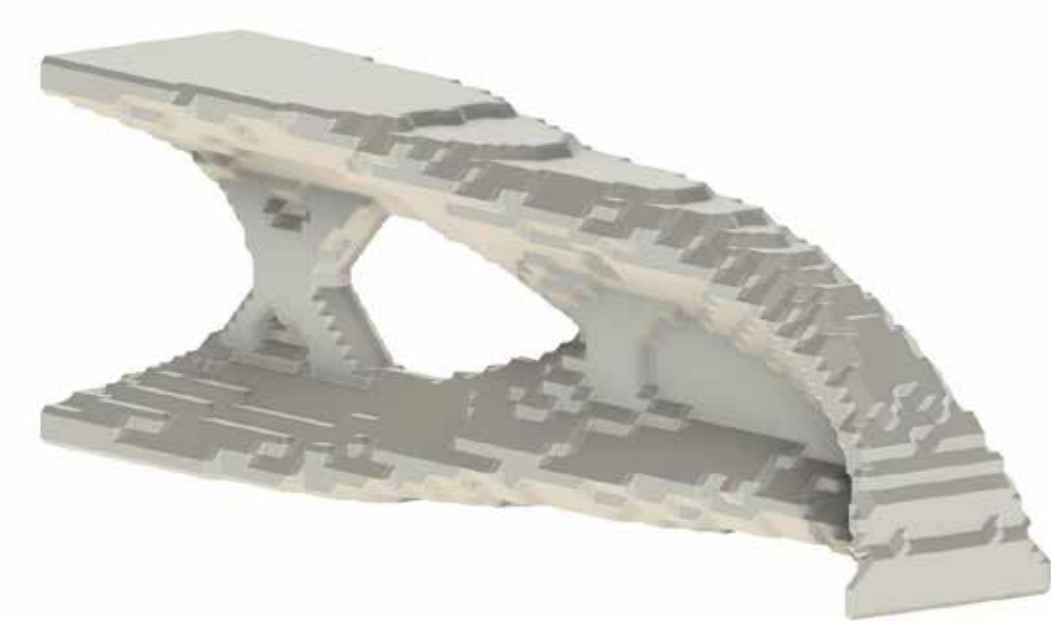
Abb. 3: Ein mit der LSM optimierter Biegebalken. (Minimierung der Nachgiebigkeit bei einer Reduktion der Masse auf 30 % des Vollmaterials)
