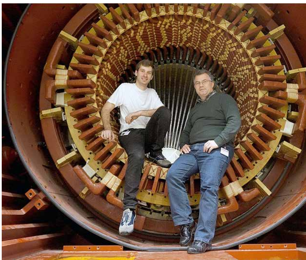
Abb. 1 und 2: Florian Zellmer und Cristian Mutascu bei der Stoßspannungsprüfung an einem 800 MW-Kraftwerksgenerator im Siemenswerk in Mülheim
