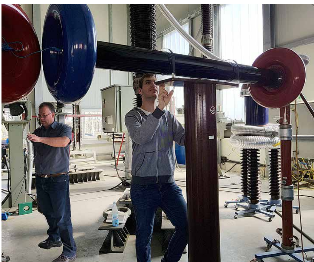
Abb. 1 und 2: Florian Zellmer und Cristian Mutascu bei der Stoßspannungsprüfung an einem 800 MW-Kraftwerksgenerator im Siemenswerk in Mülheim
