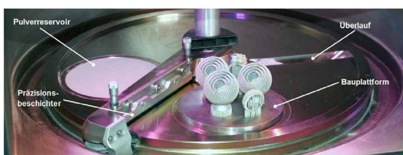
Abb. 4: Aufbau der Druckkammer
