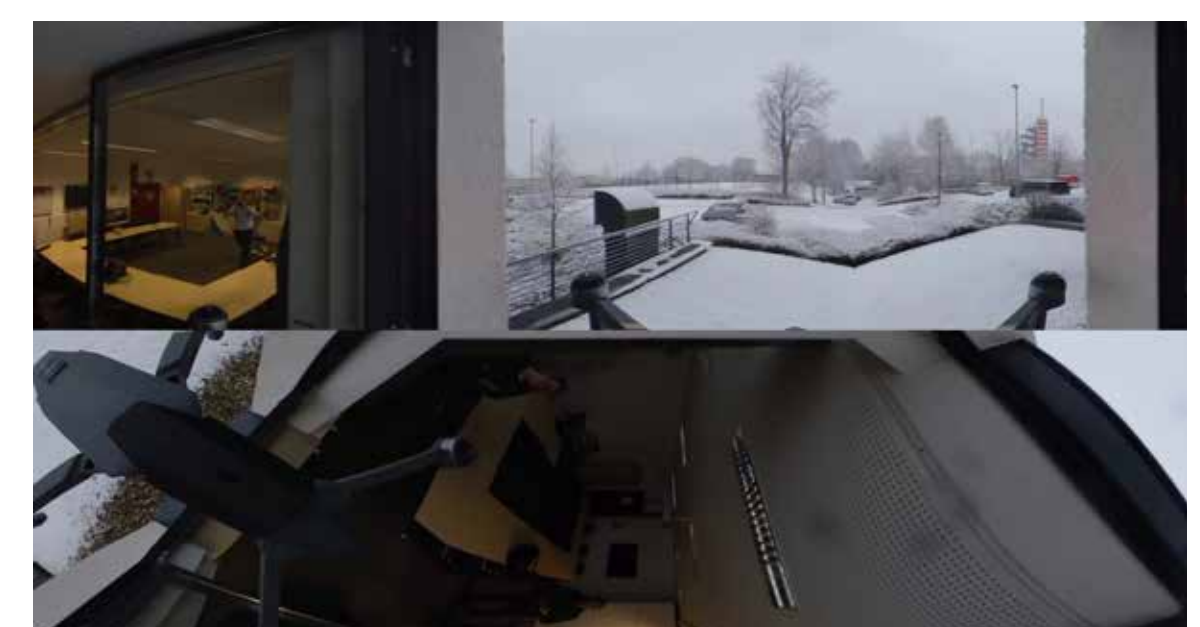
Abb. 6: 360°-Bild einer Mavic Pro mit einer ONE X 360 beim Einflug in ein Gebäude durch ein Fenster.
