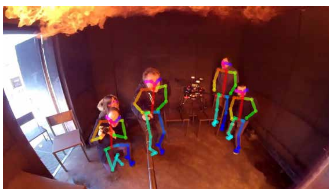
Abb. 4: Erkennung der menschlichen Pose in einem RGB-Kamerabild während eines Deckenfeuers.
