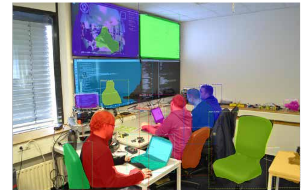
Abb. 3: Beispiel für die Szenenklassifikation eines konvolutionalen neuronalen Netzes (Mask-RCNN).
