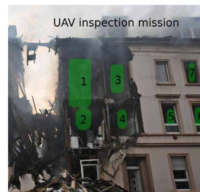
Abb. 9: Beispiel für eine Benutzerschnittstelle. Auf einem Foto werden die Bereiche markiert, die durch die kleinen Flugroboter selbständig erkundet werden sollen.
