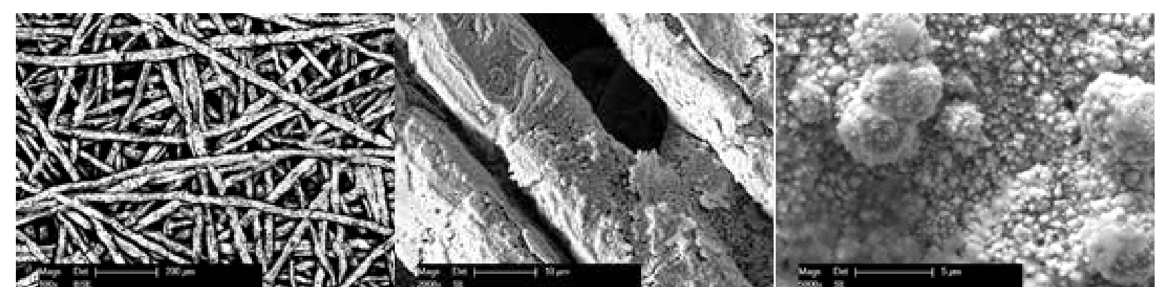
Abb.: 5 Mikroskopische Aufnahmen eines mit Platin beschichteten Titanflies (links 100x, mittig 2.000x, rechts 5.000x)
