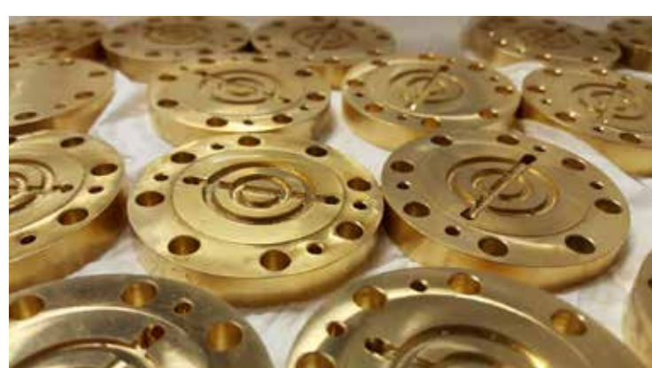
Abb.: 4 Edelstahlpolplatten mit Goldbeschichtung
