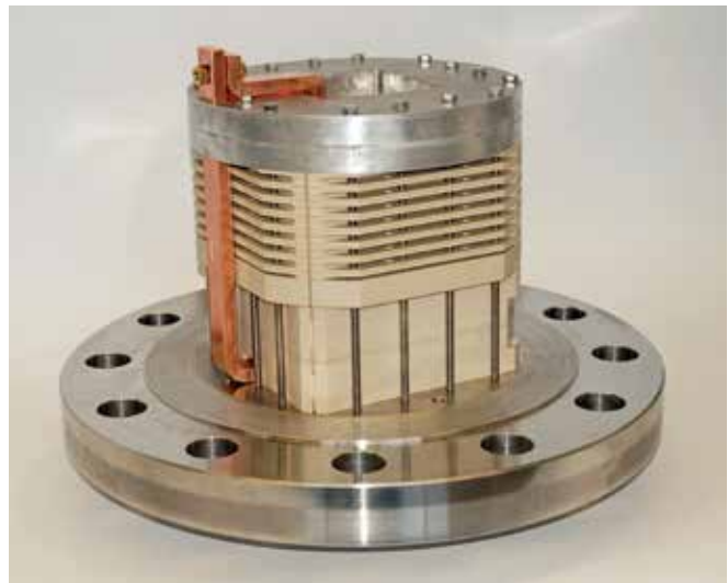
Abb. 4: Fotografie eines Hochdruck-PEMEL-Stacks nach dem Prinzip der hydraulischen Einzelzell-Verpressung.
