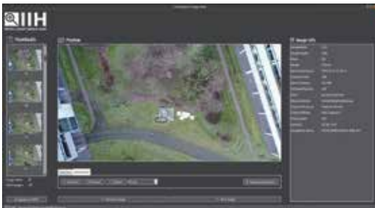
Abb. 3: Ausschnitt aus dem Intelligent ImageHub , einer Softwarekomponente zur Analyse der UAV-Bilder mittels Deep Learning und zur Berechnung der 3D-Punktwolken.
