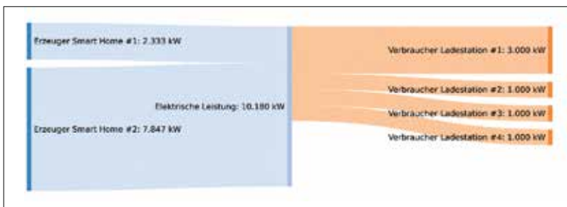
Abb. 4: Bilanzierung von Ist- und Prognosewerten mit dem Energiemanagementsystem der WH für dezentrale Erzeugungs- und Ladeleistungen der ortsnahen Ladeinfrastruktur.
