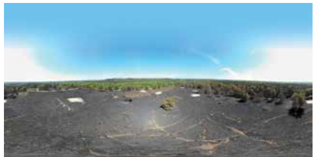
Abb. 7: 360°-Aufnahme des UAVs während des Vegetationsbrands im April 2020 in Viersen. Man erkennt die großen verbrannten Gebiete (schwarz), die das 3D-Mapping schwierig machen.
