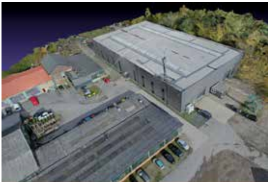
Abb. 1: 3D-Modell der Halle des DRZs in Dortmund nach einem 15-minütigen UAV-Flug und 20-minütiger Berechnung auf einem guten Desktop-PC. Noch schneller (10 Min.) geht es nur in einem speziell aufgesetzten Rechnercluster.
