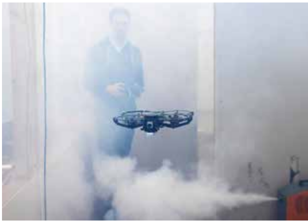
Abb. 3: Evaluierung einer neu entwickelten Micro-Drohne mit 360°-Kamera und weiterer Sensorik, unter starker Rauchbelastung.
