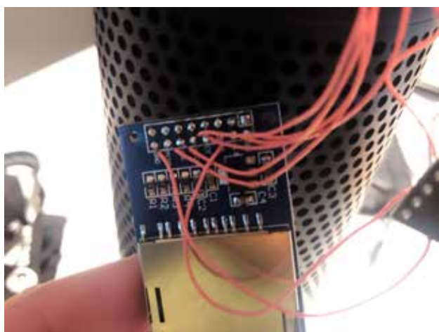
Abb. 2 und 3: Ein weit verbreiteter Sprach-Assistent wurde per angelöteter Schnittstelle so modifiziert, dass die erhobenen Sprachdaten und ihre Verweildauer im Gerät zur Laufzeit untersucht werden können.
