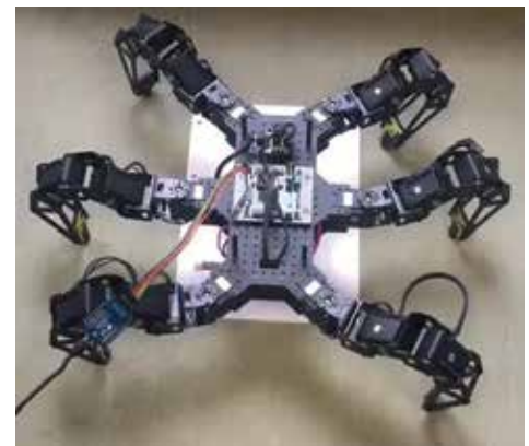
Abb. 3: Die Kraftsensoren liegen in der Nähe der Gelenke. Die Messung erlaubt der Ameise die Bestimmung der Neigung. Das Funktionsprinzip wird auf den Roboter übertragen und hierdurch ist die Positionsbestimmung im dreidimensionalen Raum möglich. Durch das Integrieren der Schritte sind keine zusätzlichen Sensoren oder externe Informationsquellen nötig.
