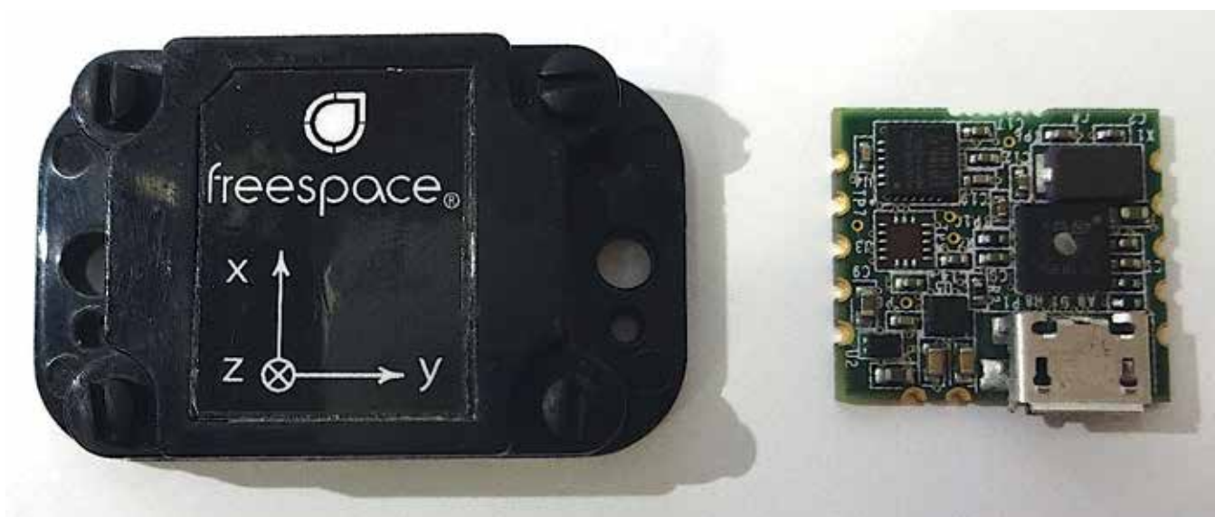
Abb.2: Der FSM-9 ist ein MARG-Sensor der Firma Hillcrest. Dieser fusioniert die Daten eines Beschleunigungs-, Drehraten- und eines Magnetfeldsensors mithilfe eines integrierten Mikroprozessors.
