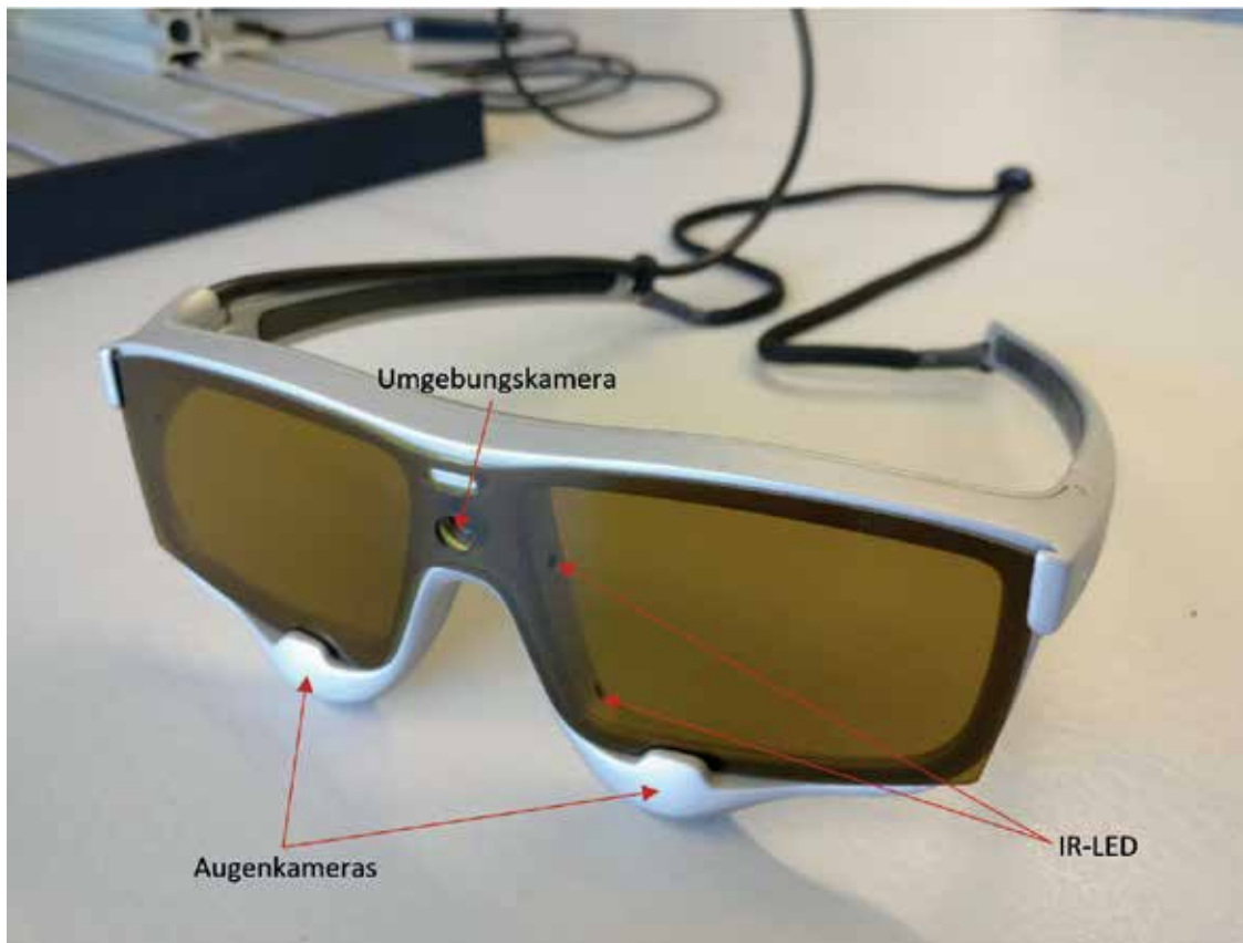
Abb.1: SMI Eye Tracking Glasses 2W Hinter dem getönten Glas befinden sich jeweils sechs Infrarot-LEDs pro Auge. Die beiden Augenkameras befinden sich in der Verdickung am unteren Rand der Brille. Die Umgebungskamera sitzt auf dem vorderen Steg der Brille.
