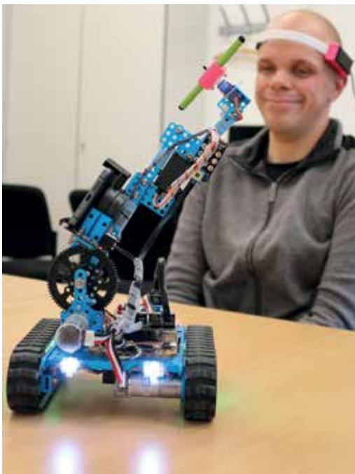
Abb. 3: SwipeBuddy im Fahrmodus Der Benutzer steuert den Roboter mittels Kopfbewegungen. Die weißen Frontscheinwerfer sind eingeschaltet und der Raupenantrieb leuchtet grün.
