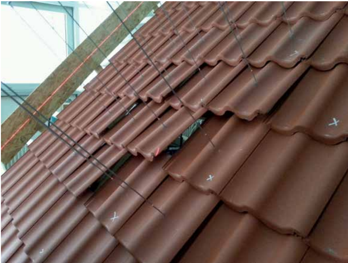
Abb. 1: Prüfstand zum Test der Sturm- federn nach EN 14437 an der Hochschule
