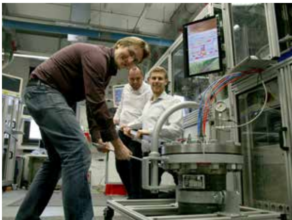
Montage des Hochdruck-Elektrolyseursystems
