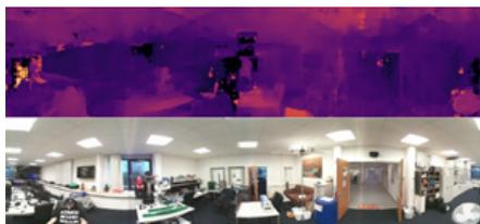
Tiefenbild (oben) und zusammengefügtes 360° Bild (unten)
