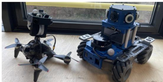
DJI FPV Drohne mit Arducam Quad-Camera Kit (links) und DJI Robomaster mit Nvidia Jetson Board und sechs Kameras (rechts)
