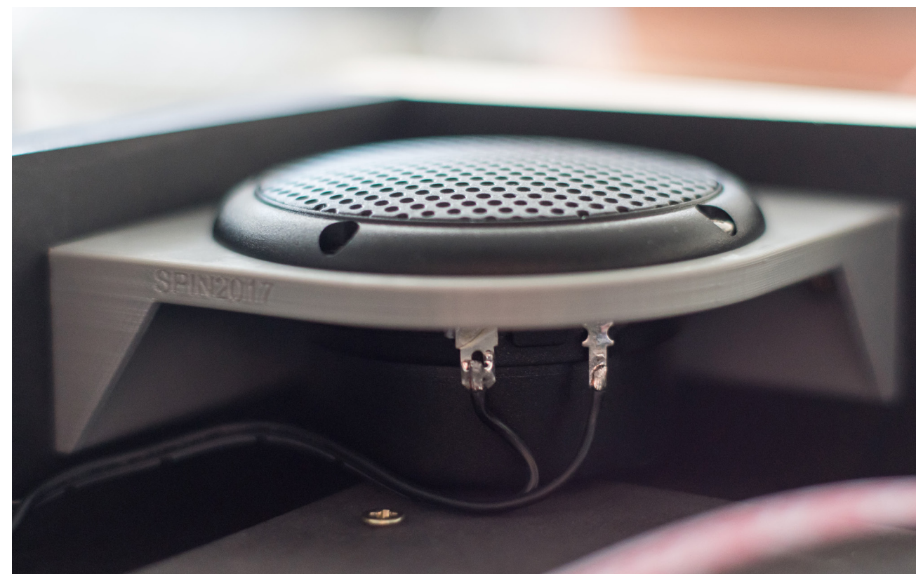
3D gedruckter Rahmen für den Lautsprecher
