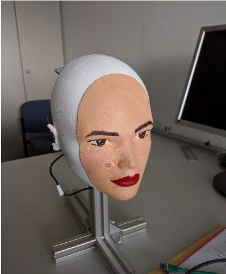
Abbildung 8.4: Mock-Up zur Referenzmessung der Kontaktkräfte
