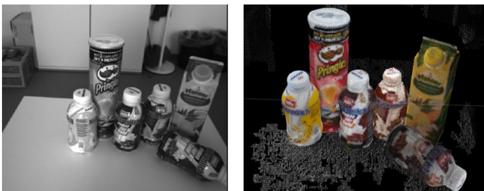
Abbildung 7.4: Erkennung und Lokalisierung von texturierten Objekten in einem Table-Top-Szenario: Grauwertbild der Roboception Stereokamera (links). Punktwolke mit erkannten Objekten gerendert als Farbmodelle (rechts).
