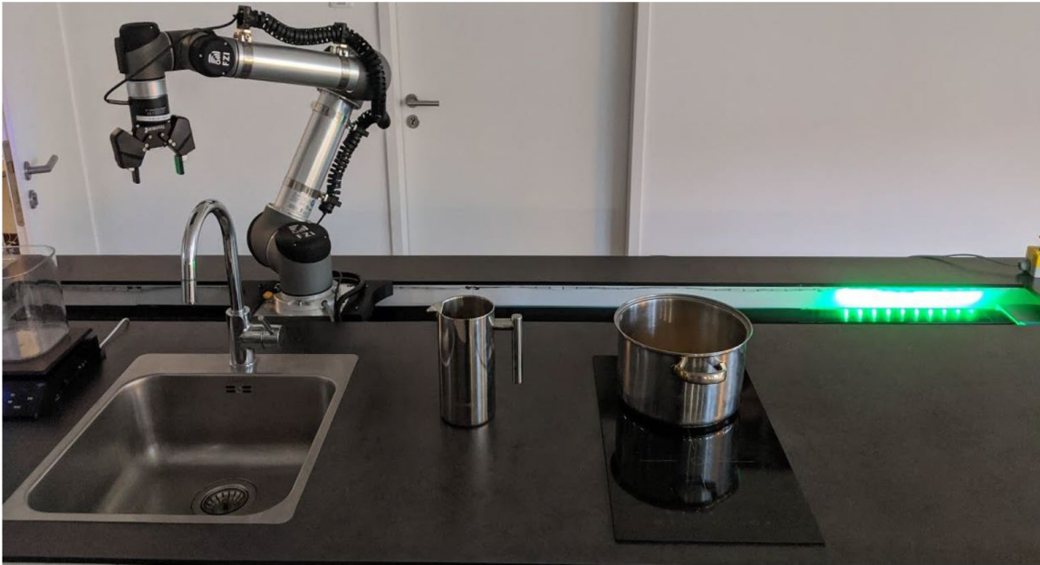
Abbildung 11.7: Der Roboterarm montiert auf einer Linearachse. Der LED- Streifen visualisiert den Fahrweg des Roboters
