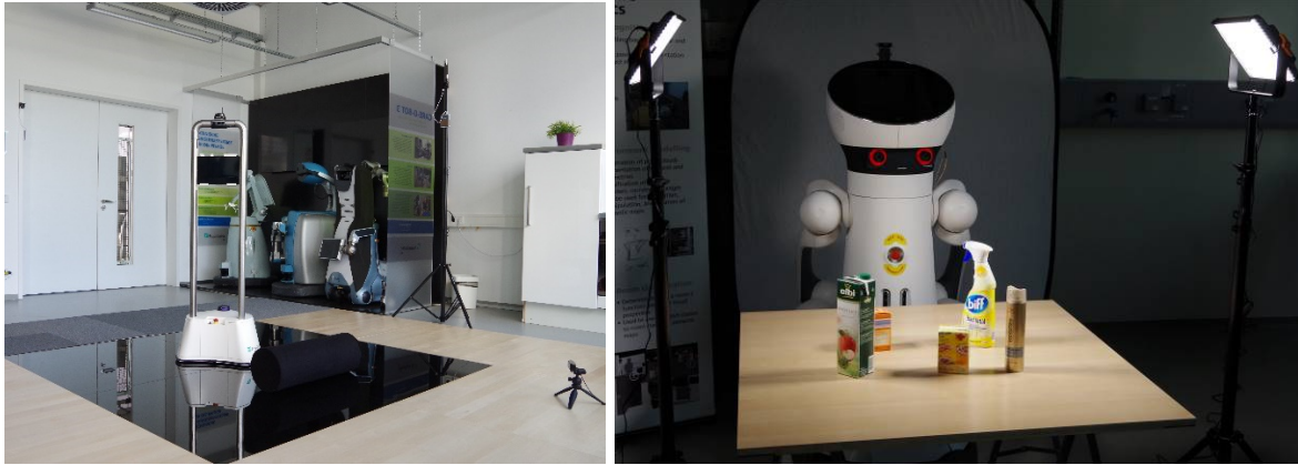
Abbildung 1.3 Testaufbauten für die Hinderniserkennung und -vermeidung (links) und für die Objekterkennung unter wechselnden Lichtverhältnissen (rechts). Quelle: Fraunhofer IPA / Theo Jacobs
