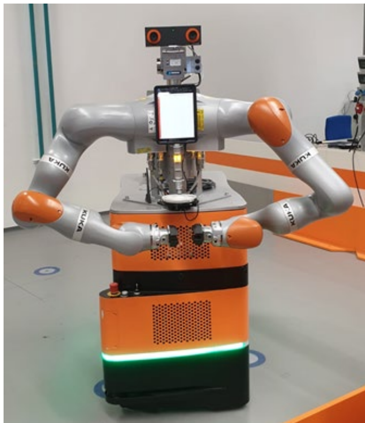
Abbildung 5.21: Integriertes zweiarmiges mobiles System als Evaluierungssystem
