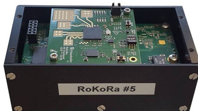
Abbildung 10.12: RoKoRa-Radarsensor mit geöffnetem Gehäuse
