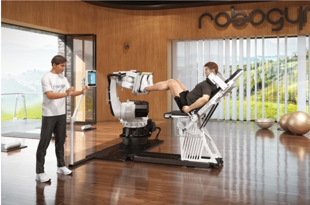
Abbildung 5.4: Integration der RoboGym Trainingsplattform in den Versorgungsalltag von trainierenden Personen. Direktes Biofeedback über gelenkspezifische Belastung erfolgt direkt über das Display oder via Operator.
