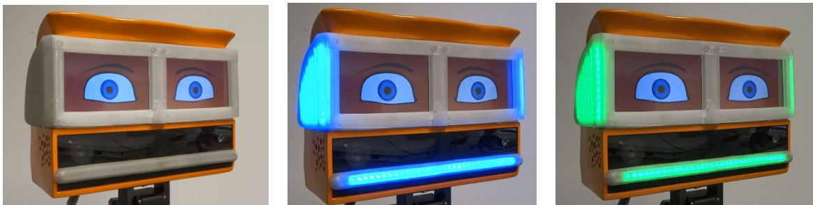
Abbildung 12.3: links: LED-Ausgabe aus; mitte: LED-Ausgabe blau; rechts: LED-Ausgabe grün
