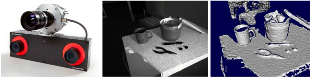
Abbildung 7.3: Die Roboception Stereokamera rc_visard mit Projektor (links). Eine Beispielszene mit projiziertem Muster (Mitte). Die mittels SGM und dem Primal-Dual-Algorithmus rekonstruierte und gegl ttete 3D-Szene (rechts).
