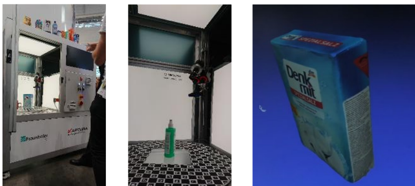
Abbildung 7.6: Prototyp der ScanStation (links) mit integrierter Stereokamera rc_visard und Musterprojektor von Roboception (Mitte). Ein beispielhaftes mit der ScanStation erstelltes Objektmodell (rechts).
