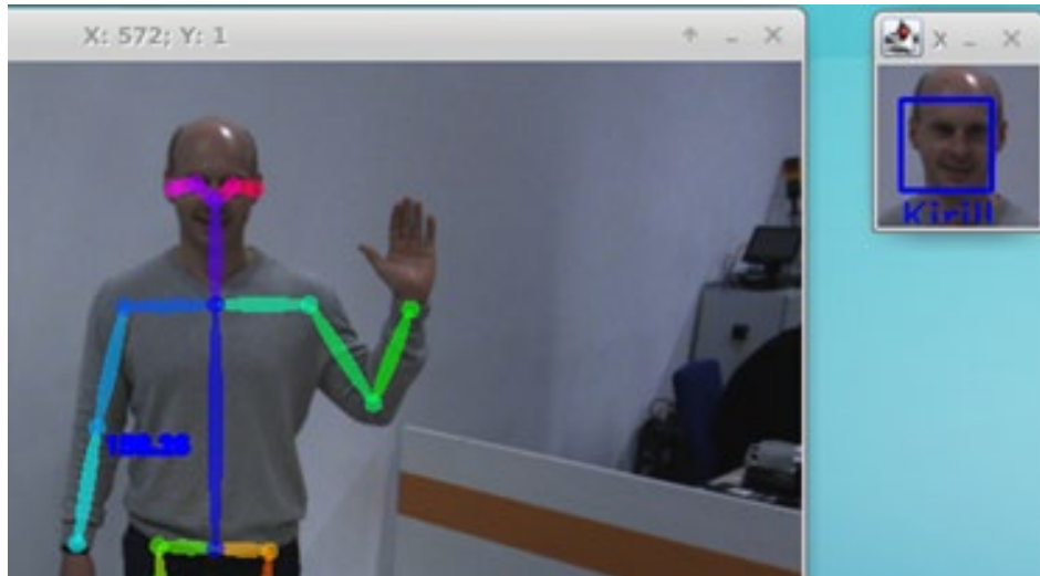
Abbildung 5.15: Identifikation des Nutzers durch Gesichtserkennung (rechts oben) und Erkennung von Gesten (Heben einer Hand)
