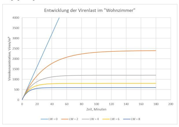
Die blaue Kurve für LW = 0 stellt den Fall von geschlossenen Fenstern und Türen dar (keine Lüftung oder Reinigung). Hier steigt die Virenkonzentration gleichmäßig an. Bei einer entsprechenden Lüftung bzw. Reinigung (LW = 2 1/h bis LW = 8 1/h) wird nach einiger Zeit eine konstante Virenkonzentration erreicht. In allen Fällen spielt die Kontaktzeit der gesunden Personen mit der infektiösen Person eine wesentliche Rolle; das Risiko steigt jedoch mit höherer Virenkonzentration in der Raumluft.
